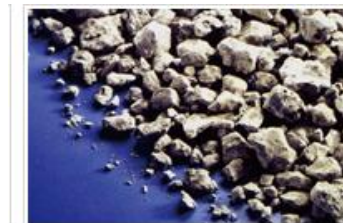
Steelmaking slag (converter slag)
